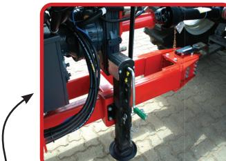
• Sistema de engate com regulagem de altura e boca de lobo para diversos tipos de tratores.
