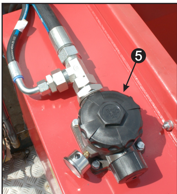
Foto. 25 - Filtro de Retorno Tanque Hidráulico
