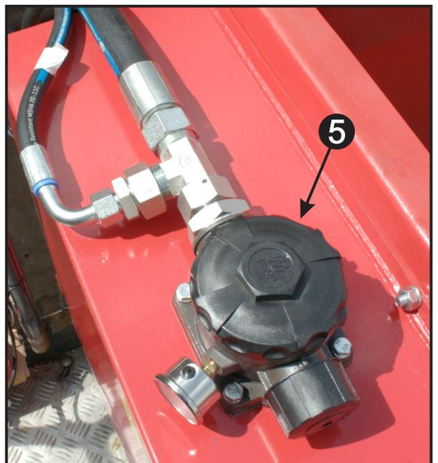
Foto. 25 - Filtro de Retorno Tanque Hidráulico
