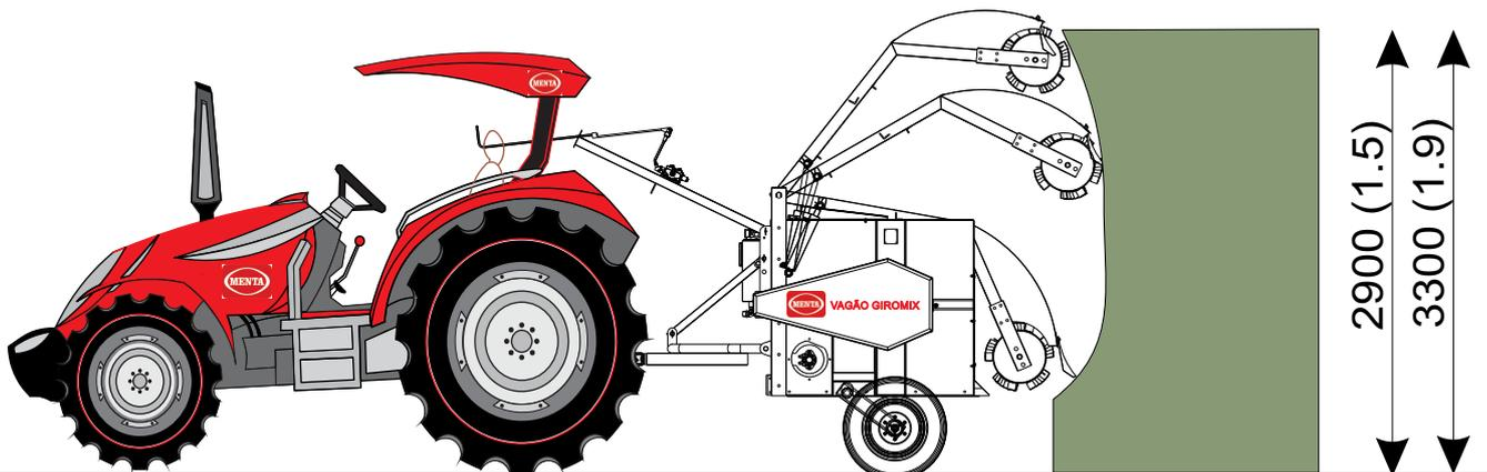
**NOTA:** Excesso de carga ou resistência excessiva danificam a estrutura do equipamento.
