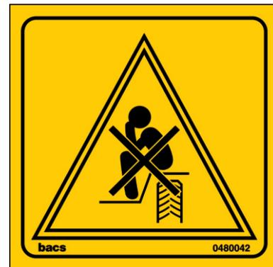
Nunca se aproxime da fresa alimentadora com o equipamento funcionando. Mantenha distância da área de alimentação.
